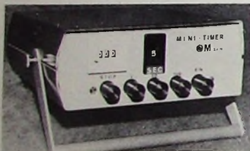
Bild 13. Ansicht des Zeiträffergerätes für elektrisch ausgelöste Filmkameras nach Bild 12
