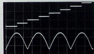
Bild 3. Die aus der Netzspannung gewonnene Kollektorspeisespannung (untere Kurve) synchronisiert die stufenweise ansteigende Steuergröße (obere Kurve), so daß bei jeder Halbschwingung (10 ms) nacheinander zwei Kennlinien dargestellt werden.
